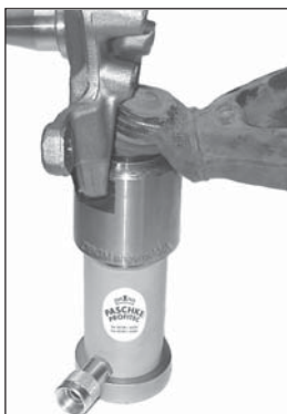
Sprinter Traggelenk mit 33 517 301 Ausbau aus dem Achsschenkel
