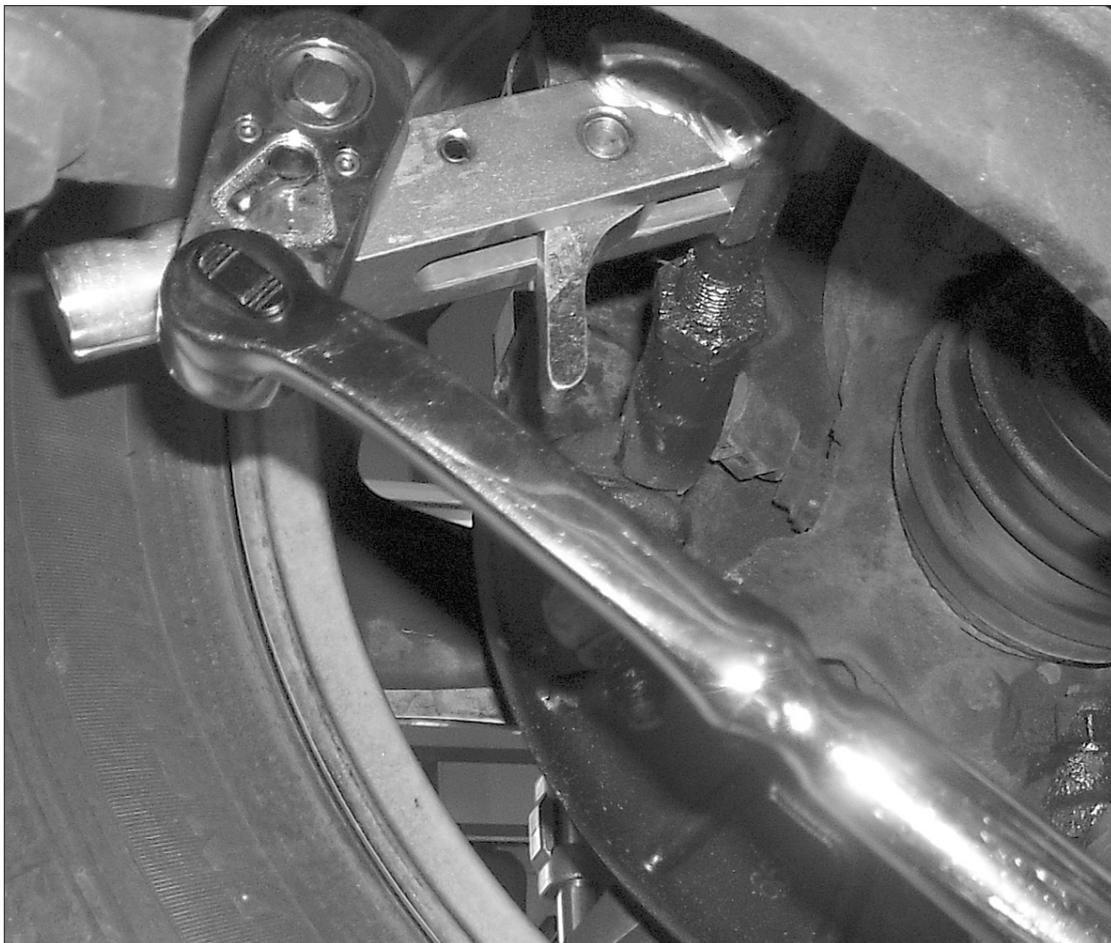
Durch den Einsatz einer Ratsche ist jeder beliebige Winkel zum Ansetzen einstellbar. Somit auch auf dem Achsmessstand verwendbar.
