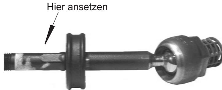
Die breite Auflagefläche verhindert die Beschädigung der Spurstange.
