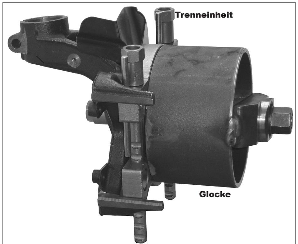
Ausbau **aller** geschraubten Radlager und **aller** geschraubten Radlager-Nabeneinheiten (HA) :
