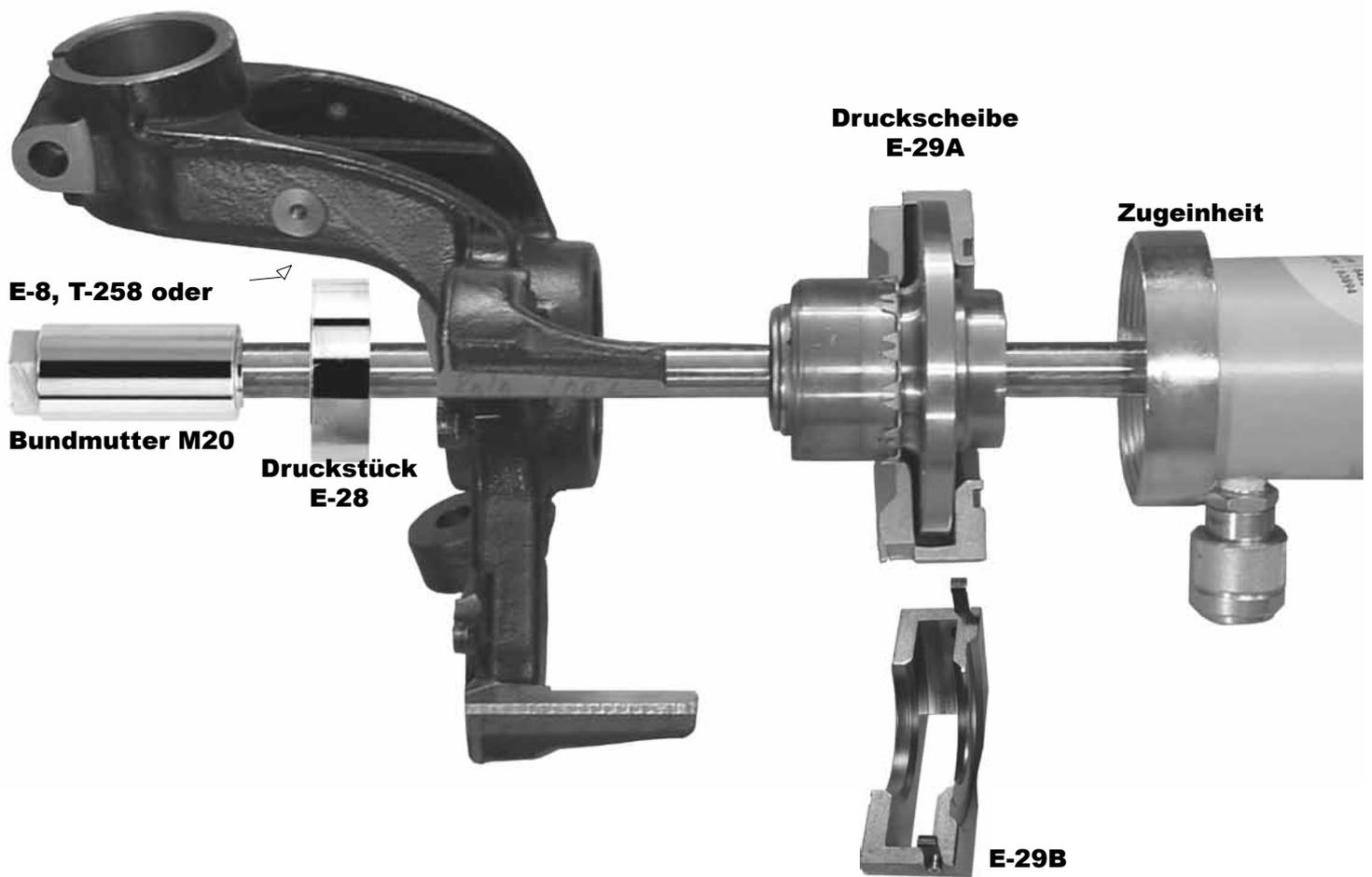
Für Einbau Kompaktlager **Ø 62mm** (z.B. Lupo 3L)
