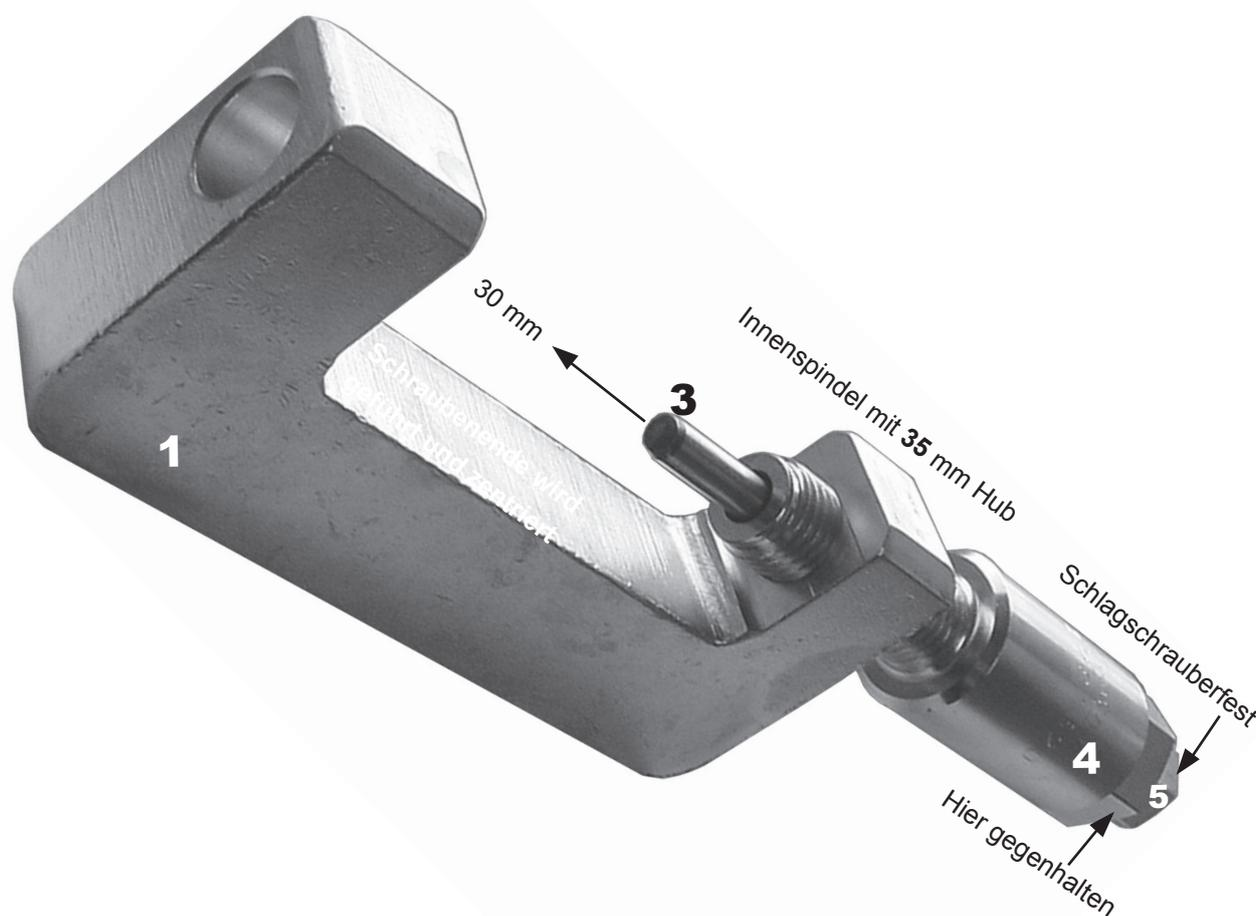
Achtung: Vor Benutzung die Druckschraube (5) **zurückdrehen** bis der 8 mm Innenstift in der Schraube (4) verschwindet. Werkzeug über den Schraubenkopf setzen, Schraubeneinde im Werkzeug aufnehmen, dann handfest anziehen. Die Schraube (4) mit einem Schlüssel (SW 30) gegenhalten. Stift kann ca. 30 mm in die Achse gedrückt werden. - Spindel nachrüstbar, Innenstifte einzeln lieferbar -
