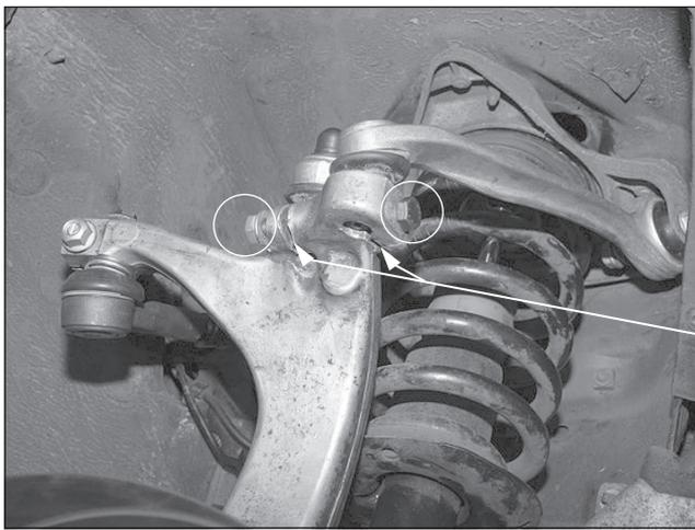
Durch die Klemmschlitze die Sicherungsschraube durchtrennen. Dann jeweils Kopf und Mutter fassen und herausziehen.
