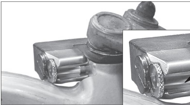
Die Öffnung zur Führung zudrehen, so das die Sicherungsschraube nur gerade herausgedrückt werden kann. Sicherungsschraube soweit wie möglich ausdrücken. Anschließend den Ausdrücker abnehmen.
