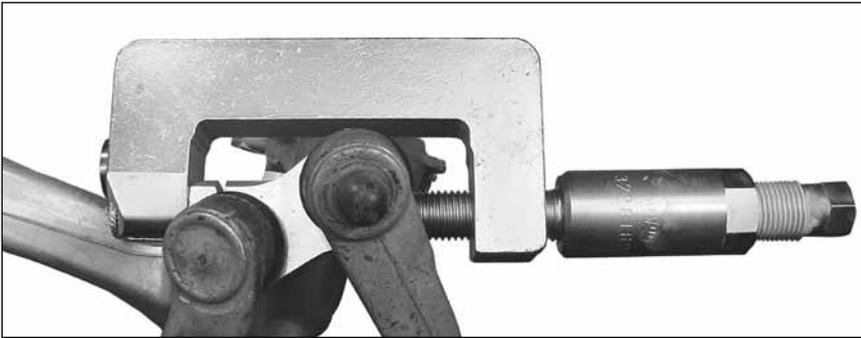
Zunächst die Sicherungsschraube mit dem Werkzeug ausdrücken. Sollte dies aufgrund der extremen Korrosion scheitern, dann weiter mit .....
