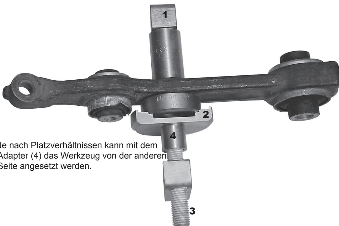
Je nach Platzverhältnissen kann mit dem Adapter (4) das Werkzeug von der anderen Seite angesetzt werden.
