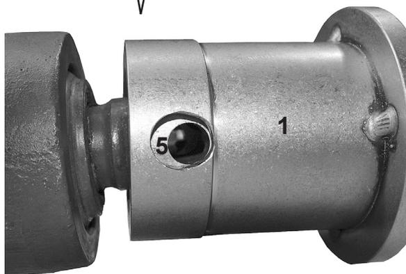
Zusammen auf das Molekularlager aufsetzen, die Bohrungen übereinander zur Deckung bringen und mit Bolzen arretieren.
