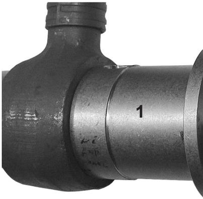
Zughülse (1) kann beidseitig verwendet werden um eine gute Auflagefläche am Lenker sicherzustellen.
