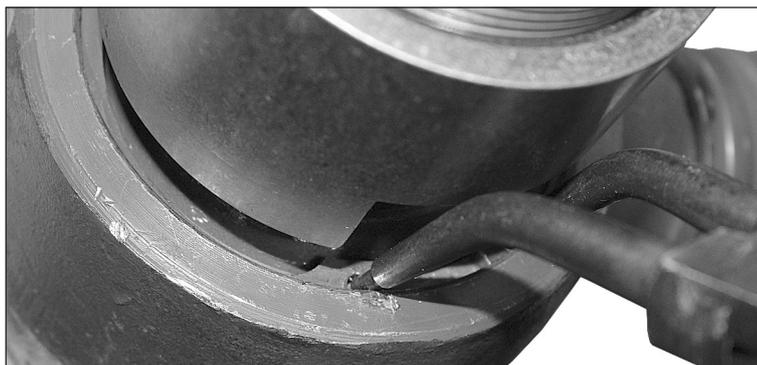
Das Molekularlager wird durch den Zug gespannt, so das sich der Seegerring leicht entfernen läßt und das alte Lager herausgezogen werden kann **oder** der Seegerring in die Nut eingesetzt werden kann.
