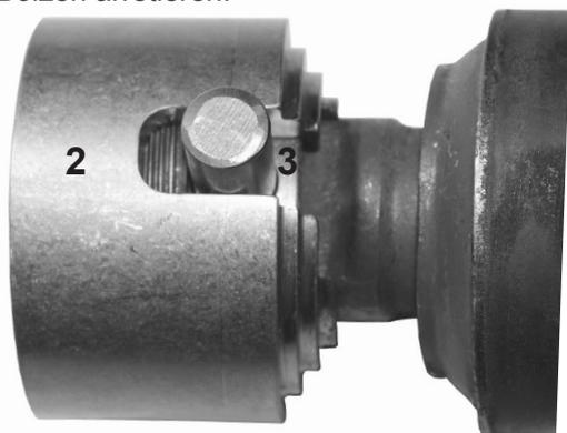
Das Spannteil außen (2) locker bis an das Molekularlager schrauben.
