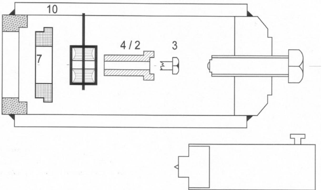
Auge gut vom Rost reinigen und Lager zur Montage fetten
