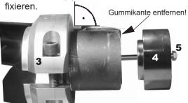
Druckring (8) auf Lagerkragen setzen. Druckstück Ausbau (7) ansetzen und mit Zentrierung (5) fixieren. Die Lagerkante des Kunststofflagers wird durch die Abstützzapfen (von 8) bewußt
