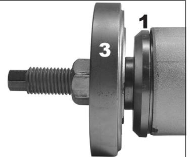
Gegebenenfalls beim Einbau das Druckstück 1 zusätzlich für Aluminium-Lager verwenden.
