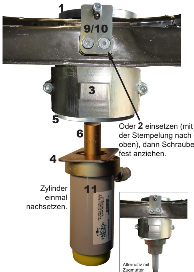
Zylinder einmal nachsetzen.
