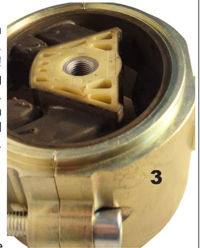
Für den optimalen Einbau das Lager minimal unter der inneren Kante positionieren.
