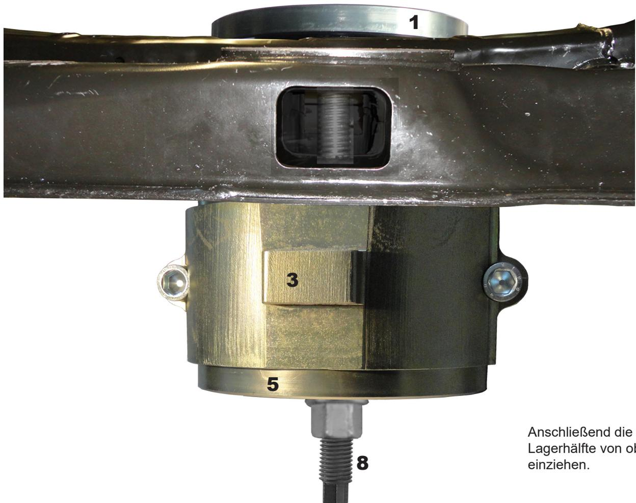
Anschließend die 2-te Lagerhälfte von oben einziehen.
