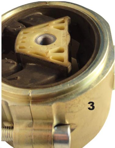
Für den optimalen Einbau das Lager minimal unter der inneren Kante positionieren.
