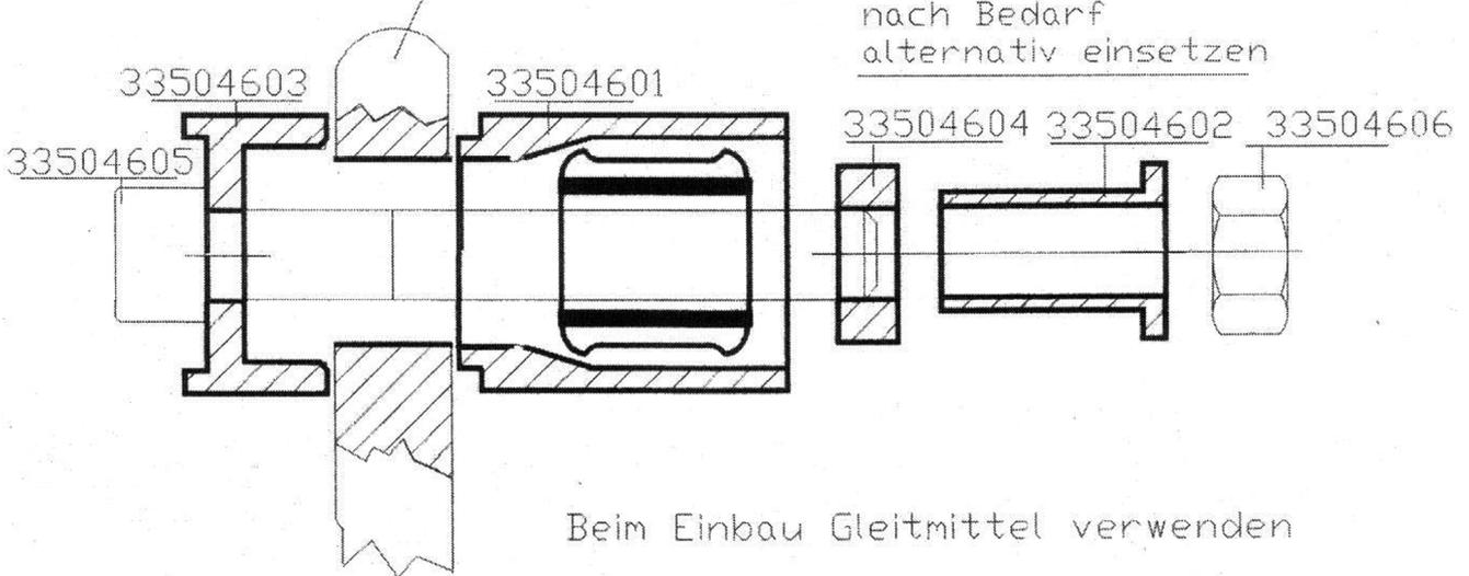
Beim Einbau Gleitmittel verwenden
