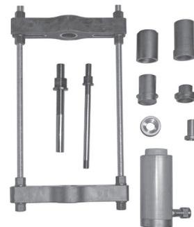
**Achsschenkelbolzenpresse mit 28t Zylinder**
