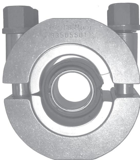
Vorgespanntes Lager mit Halbschalen in die neue Hülse 33 505 609 ziehen.
