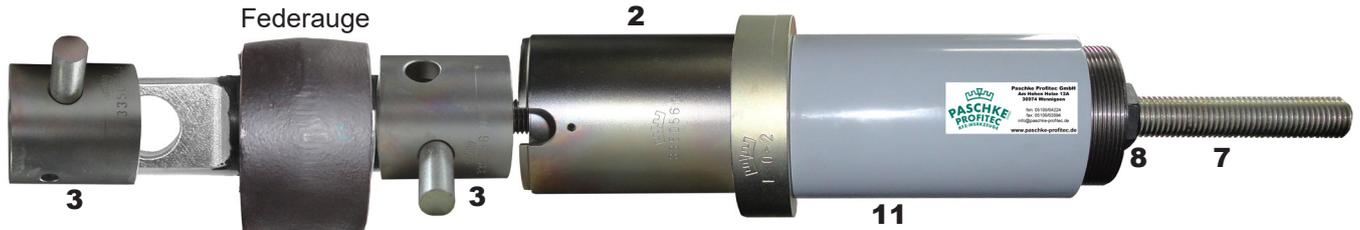
Zughülsen (3) über wird nur der Zapfen Zugbolzen (7) durch Jetzt das Lager herausziehen.
