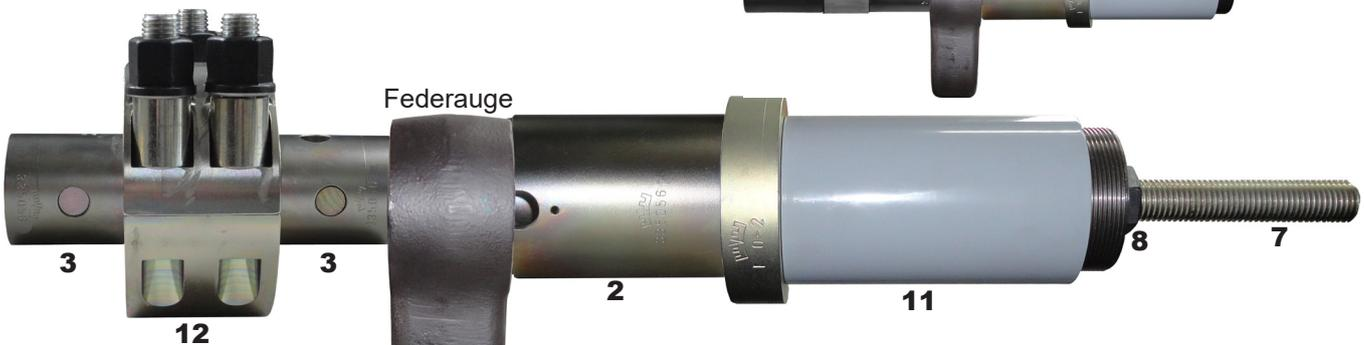
Zughülsen (3) über die Zapfen stülpen, mit den Bolzen arretieren. (Beide Zughülsen benutzen, ansonsten wird nur der Zapfen herausgezogen und das Gummi bleibt stecken). Distanzhülse (2) aufsetzen. Zugbolzen (7) durch Hohlkolbenzylinder (11) und Distanzhülse (2) in die Zughülse (3) einschrauben. Jetzt das Lager aus dem Spannblock (12) in das Federauge einziehen.
