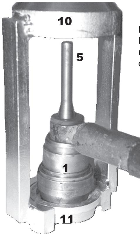
Beim Ausbau der Dämpfergummi muß die Kerbe oben sein.
