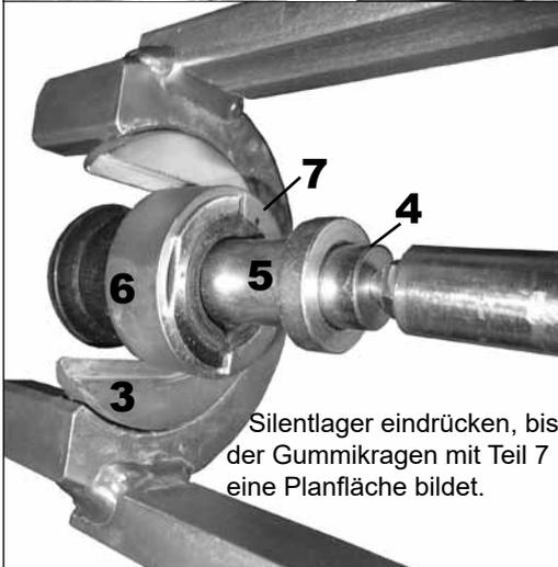
Eingedrücktes Silentlager aus dem Standard herausnehmen. Nummer 4 und 5 von der anderen Seite in das Silentlager einsetzen.
