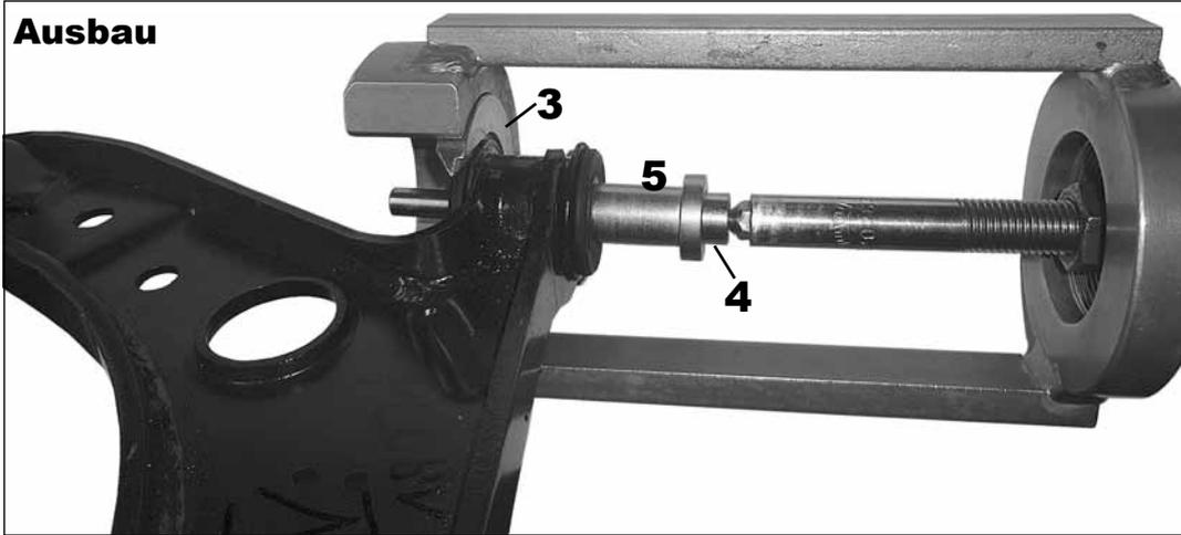
Silentlager zwischen Teil 7 (Halbschalen) legen und im Schraubstock zusammendrücken.
