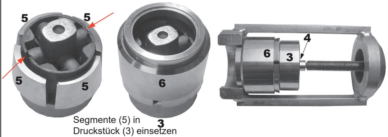
**Einbau (in die Achse)** Bei Stahlbuchsen entfällt Teil 6.
