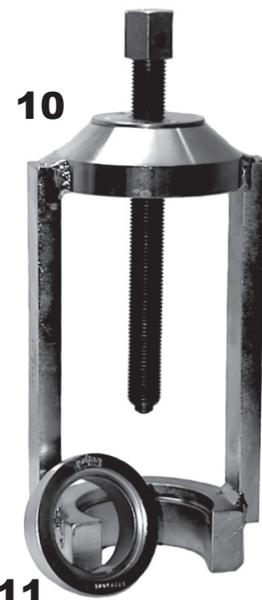
**Ausbau:** Nach Ansetzen der Teile 1, 2, 4 und Standard, die Einpresstiefe des alten Lagers in Druckstück 2 markieren und für das neue Lager übernehmen.
