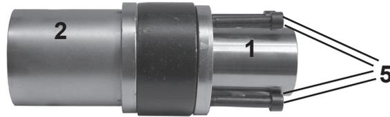
Distanzhülse (6) aufsetzen, Zugbolzen (8) durch Hohlkolbenzylinder (10) und Distanzhülse (6) in die Zughülse (1) einschrauben. Jetzt das Lager herausziehen.
