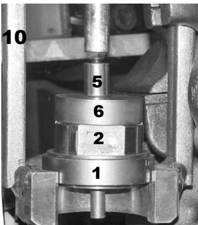
Vorgespanntes Lager mit den Halbschalen in den Standard (10) einlegen und mit Druckstück (6) tiefer in den Ring (1) eindrücken.
