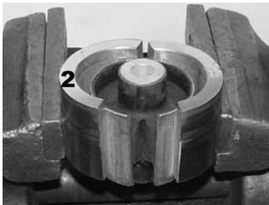
Neues Lager eingefettet in die Halbschalen (2), wie auf Abbildung, in den Schraubstock einlegen und vorspannen bis der Ring (1) aufgesetzt werden kann.
