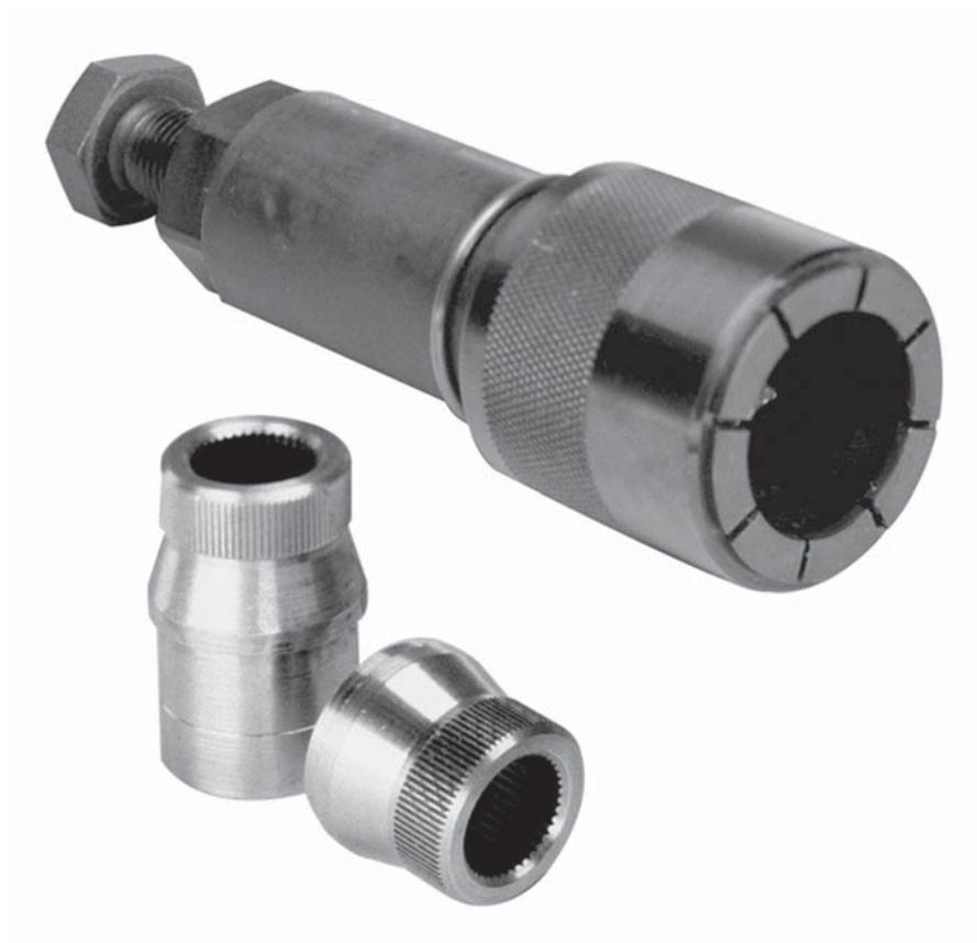
Dies Profitec-Werkzeug fasst mit 8 Armen lückenlos und exakt um die Adapterhülse und wird mit der Überwurfmutter verspannt, so das ein seitliches Ausweichen der Arme und eine Beschädigung der Adapterhülse nicht möglich ist.
