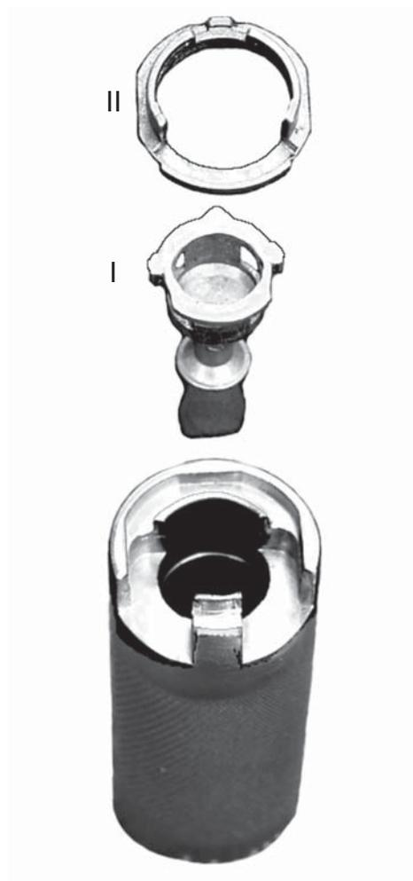
**Montagehinweis:** Schließzylinder mit dem Fahrzeugschlüssel in den Schraubstock spannen. Teile I und II wie in der Abbildung gezeigt einlegen. Auf vormontiertem Schließzylinder aufsetzen und unter leichtem Druck rechtsdrehend das Federende bis hinter den Zapfen bringen. Dann etwas zurückdrehen bis der Zapfen von Teil II einrastet. Sicherung einschieben.
