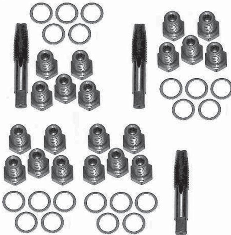
In einem Arbeitsgang wird das beschädigte Ölwanngewinde herausgeschnitten und um eine Größe erweitert. Statt der Original-Verschlusschraube wird eine größere Verschlusschraube mit passendem Dichtring eingeschraubt.
