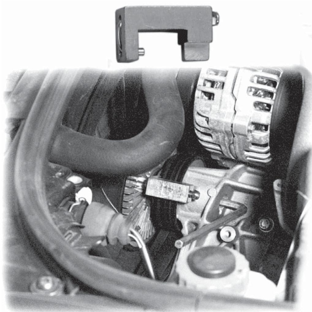
Ohne Beschädigung von Riemenscheibe und Alugehäuse wird eine 100% sichere Arretierung beim Ein- und Ausbau des Viscolüfters erreicht. Kein Abgleiten des Werkzeuges und somit keine Verletzungsgefahr.
