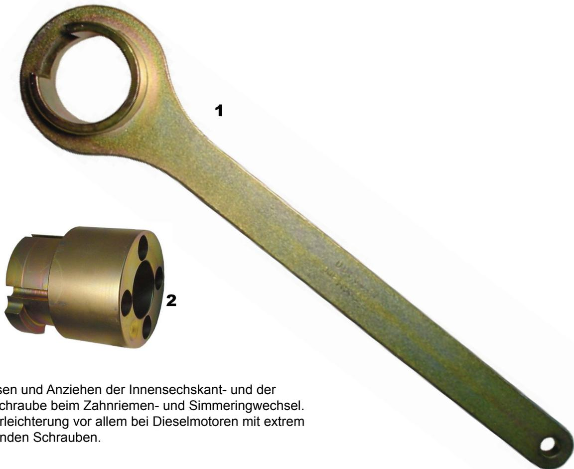
Zum Lösen und Anziehen der Innensechskant- und der Zentralschraube beim Zahnriemen- und Simmeringwechsel. Arbeitserleichterung vor allem bei Dieselmotoren mit extrem festsitzenden Schrauben.
