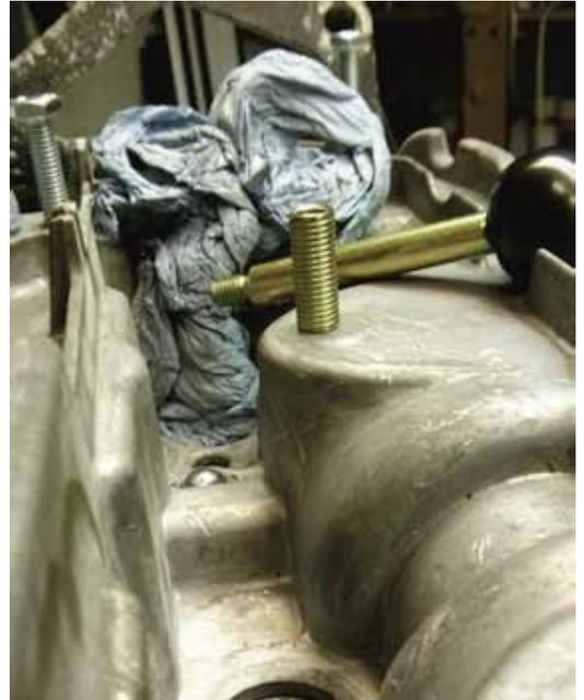
Nun kann der Injektor mit neuen Original MB Dehnschrauben wieder befestigt werden. Bitte beachten Sie hierbei, dass nur neue Schrauben verwendet werden und diese mit einem Drehmoment von 15 Nm und 90 Grad angezogen werden.
