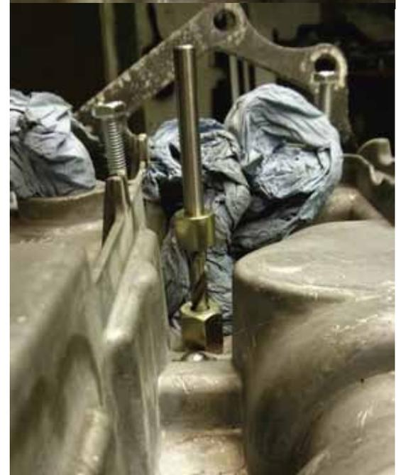
**Schritt 3: Der von 8 mm auf 7 mm abgesetzte Kernlochbohrer (3) vergrößert nun im Kopf die 6er-Bohrung für die Gewindehülse M8x1 (außen). Bitte auch hier bis zum Anschlag (68 mm) bohren und das Bohrloch unbedingt von Spänen befreien (ausblasen)!**
