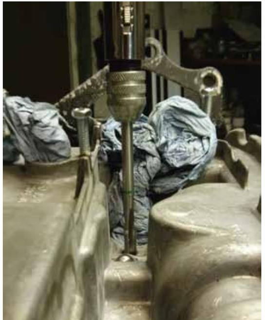
**Schritt 5: Mit dem Eindrehwerkzeug (5) wird jetzt eine Gewindehülse M6x1/M8x1 (6) in das geschnittene Gewinde eingedreht. (Bei Bedarf evtl. mit Gewindefest (z.B. Loctite®) fixieren).**
