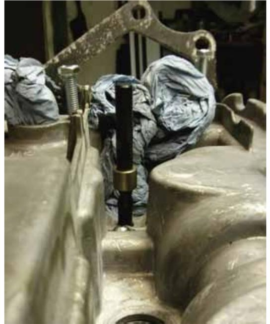
**Schritt 4: Mit dem Gewindebohrer M8x1 (4) wird nun ein Gewinde geschnitten für die Gewindehülse. Bohrloch wieder von Spänen befreien (ausblasen)!**
