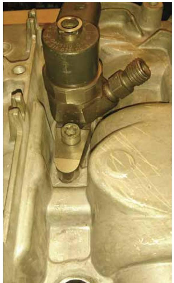
Die speziell angefertigten Gewindehülsen sind nicht mit ähnlichen Gewindehülsen von anderen Herstellern zu tauschen. Undichtigkeiten entstehen durch Beschädigungen oder Unsauberkeiten am Dichtsitz des Injektors und können nicht durch Nachziehen der Befestigungsschrauben beseitigt werden. Wir verweisen hier auf unsere Reinigungs-werkzeuge 51 506 300 und 51 505 300.
