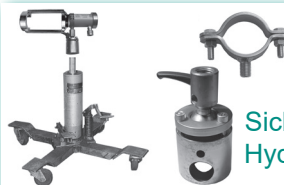
Ford Mondeo etc. HA Längslenker Lager Ø 90 am Fahrzeug wechseln.
