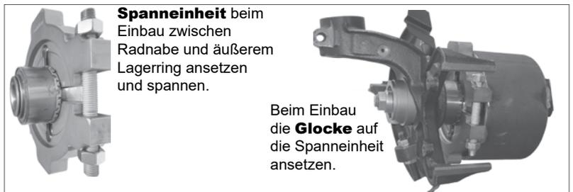
**Spanneinheit** beim Einbau zwischen Radnabe und äußerem Lagerring ansetzen und spannen.
