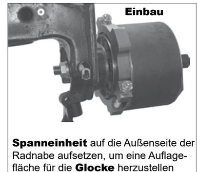
**Spanneinheit** auf die Außenseite der Radnabe aufsetzen, um eine Auflagefläche für die **Glocke** herzustellen
