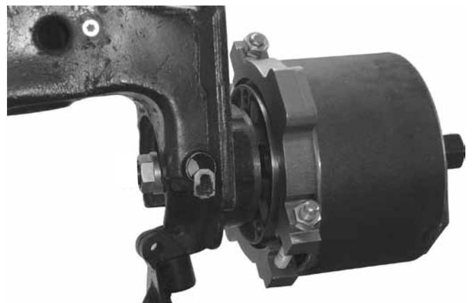
Spanneinheit T-256 auf die Aussenseite der Nabe aufsetzen um eine Auflagefläche für die Glocke herzustellen welche mittels des Zylinders den Druck ausübt.
